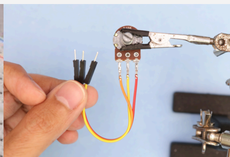
Maneira ideal, soldar fios e plugar na protoboard para ter liberdade de movimento.
